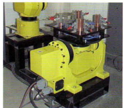
Obr. 3 Dvojosové polohovadlo FANUC so zvaračím prípravkom Fig. 3 FANUC biaxial positioner with welding jig
