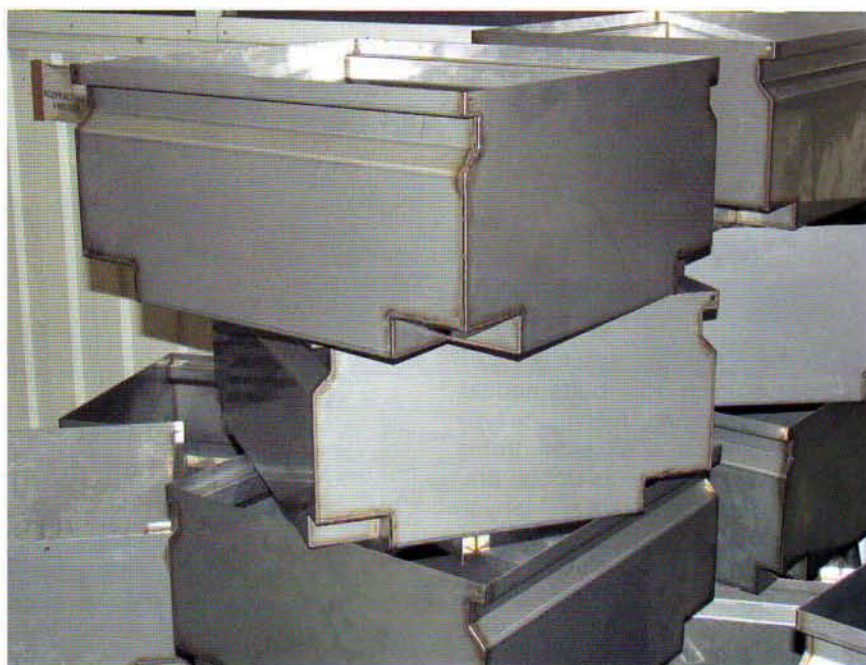
Obr.1 Nádobu zložitého tvaru na tekutiny po zvarení Fig. 1 Vessels of intricate shape for liquids in as-welded condition
